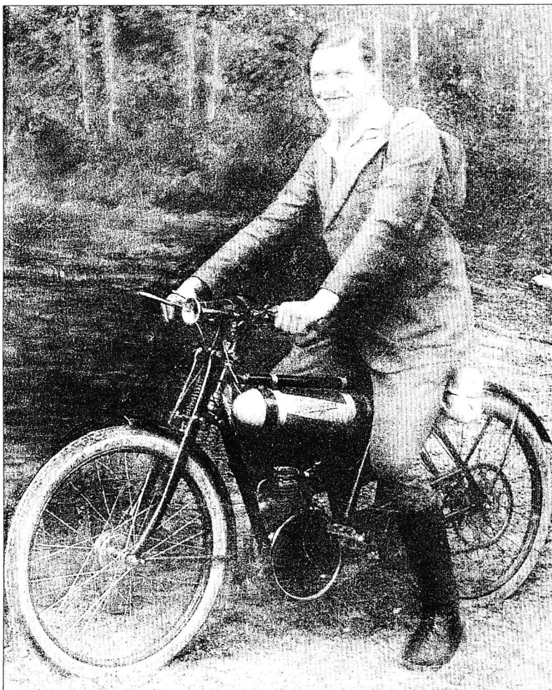
Ce souriant jeune homme pose pour la postérité sur une Motobécane B1A datant très probablement de 1931 : transmission par chaîne, apparition des freins à tambours.
