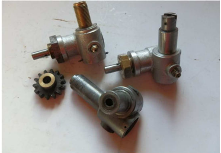
Uitvoering O.S. volgens stelsel 6 , radiale (rechte) tanden, waarbij het pignion radiaal wordt aangedreven, met haakse overbrenging; couronne wordt op wielnaaf gemonteerd.
