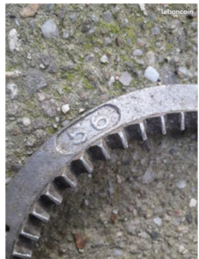
O.S. tandkrans (detail met 56 schuine tanden).
