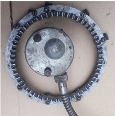
Uitvoering E.D. volgens stelsel 4 , pignon axiaal onder een hoek, hartlijn pignon snijdt niet hartlijn vooras (schuine tanden)
