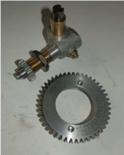
Uitvoering O.S. volgens stelsel 6 , radiale (rechte) tanden, waarbij het pignion radiaal wordt aangedreven, met haakse overbrenging; couronne wordt op wielnaaf gemonteerd.
