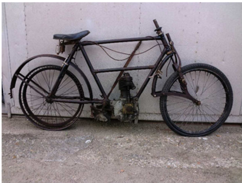
3. Geert heeft bewust gekozen om een panzadel te monteren, om de hoogte bij het aanrennen, en er op springen toch zo laag mogelijk te houden.
