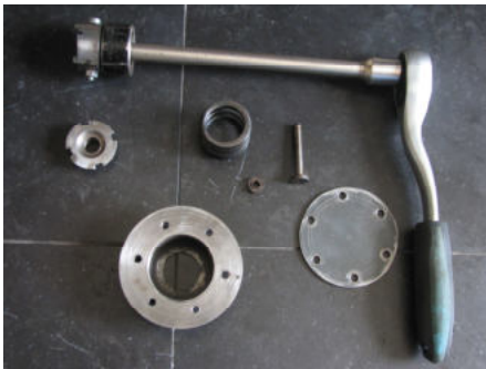
Drukstuk met afdekplaat en veer
