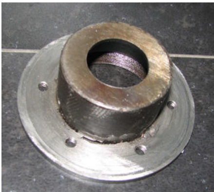
Drukstuk van de achterkant gezien. Duidelijk te zien dat de opstaande rand met de zes gaatjes er aan is gelast.
