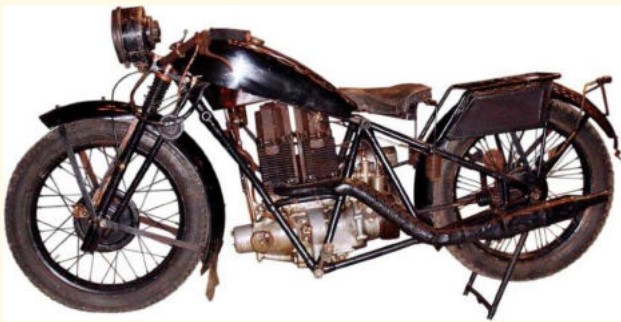
LAMOCO Twee cilinder tegen zuiger motor. (Francois-Marie Dumas met foto's uit het archief van Yves Campion)
