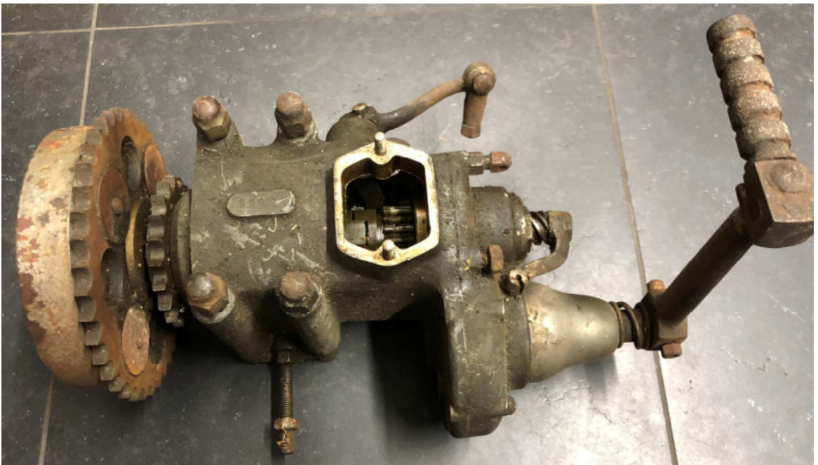
“Staande bak” van een Terrot. Dit heet zo omdat het achterframe op de plek van de montage sterk aangepast (verlaagd) om de bak neer te zetten op het frame in plaats van eronder te hangen. Door de vier bevestigingsbouten is dit een sterkere constructie dan de tweepunts-ophanging van de “hangende bak”.
