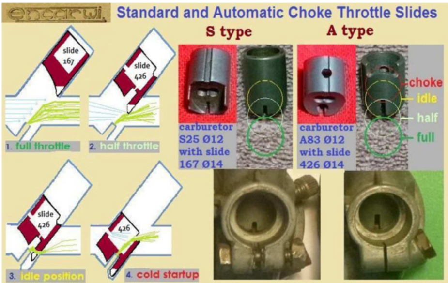
Encarwi-carburateur. 1. volgas, 2. halfgas 3. stationair-loop 4. koude start
