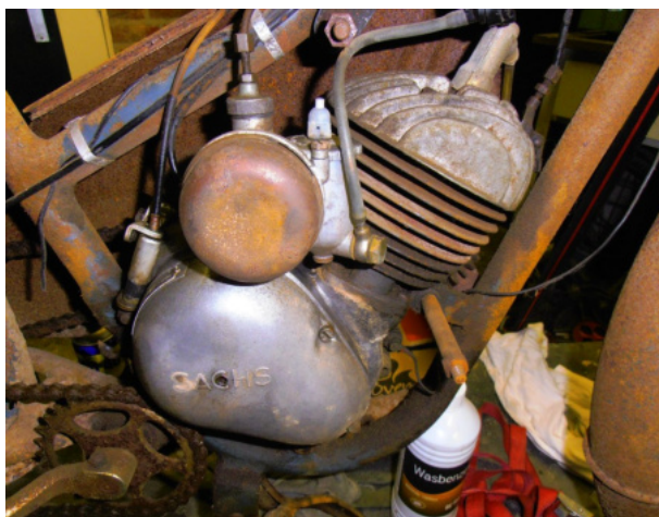
98 cc Sachs blokje, werd zo nu en dan ook in Franse motorfietsjes toegepast
