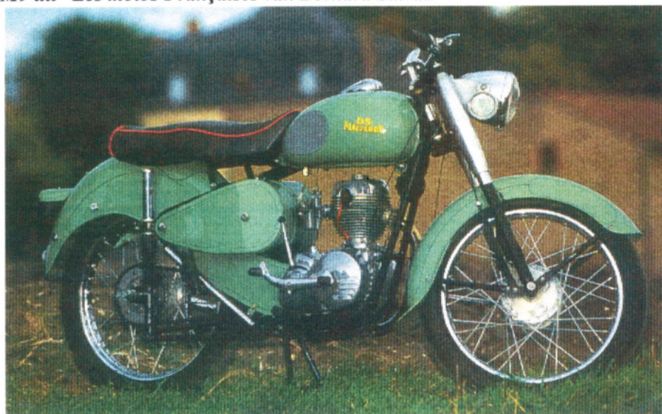
M9 van de rechterkant. De handel boven het schakelpedaal dient om de vrijstand eenvoudig in te schakelen.
