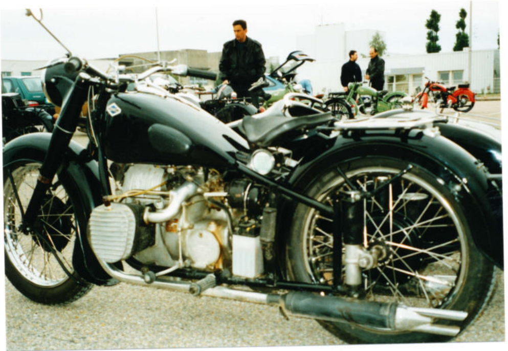
CEMEC (1948 - 1955) type L7; 746 cc zijklepmotor
