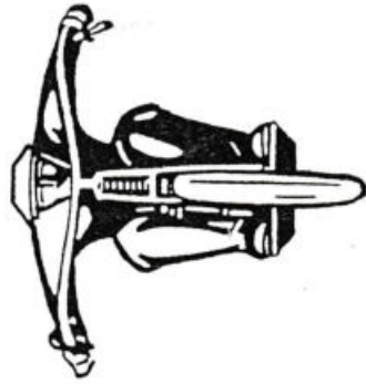
1929 : la 2CV Confort ZCT possède un double réservoir en selle.
