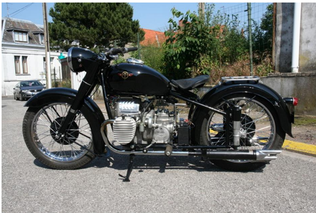
Hieronder een schitterende Ratier L7, herkenbaar aan de cilinderkoppen. En let op de specifieke uitlaat. Al met al een prachtig staaltje Franse techniek met Duitse oorsprong. Jammer van de betrouwbaarheid maar wel begrijpelijk in het licht van dwangarbeid. Er zijn 1035 machines gebouwd waaronder geteld ook een stel C8 kopkleppers.
